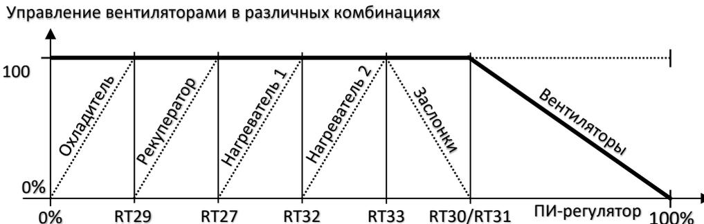
Параметры для настройки интервалов регулятора температуры воздуха доступны в общем списке «параметров регулятора температуры» РЕГУЛЯТОР ТЕМПЕРАТУРЫ (СПИСОК **RT**).
