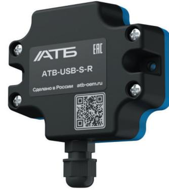
Радарный датчик непрерывно излучает радиоволны, которые отражаются от объекта контроля и регистрируются устройством. Встроенный микроконтроллер производит первичную обработку показаний с датчика в соответствии с предустановленными параметрами мониторинга. Передача контролируемых параметров на радиомодем осуществляется по проводному интерфейсу USB.
