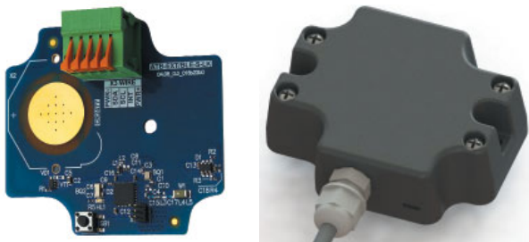
Рисунок 2. Внешний вид устройства: а) плата без корпуса, б) в корпусе.
